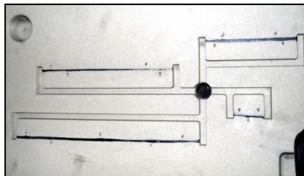
Fig. 2. Mold for Althoff-Radtke test
